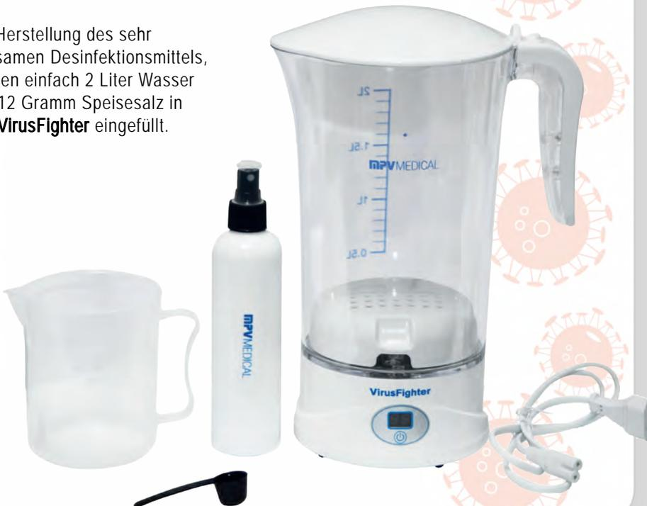
Der **VirusFighter** hat drei Zeitfenster und Konzentrationen: Es können stabile Desinfektionsmittel-Konzentrationen von 200 ppm bis zu 1000 ppm HOCl hergestellt werden: Die in 5 Minuten produzierte Konzentration an Hypochlorsäure beträgt ca. 200 ppm, die in 15 Minuten ungefähr 500 ppm und die in 30 Minuten etwa 1000 ppm.
