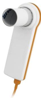
Das Gerät dient der Messung der Atemfunktionsparameter und der Aufzeichnung der Sauerstoffsättigung und der Pulsfrequenz. Hervorstechende Eigenschaften des Gerätes sind seine flexiblen Einsatzmöglichkeiten, seine Zweckmäßigkeit und die einfache Funktionsweise.
