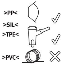
IT> Nella disinfezione in forno a microonde è possibile inserire qualsiasi accessorio fornito in dotazione, ad eccezione del tubo in PVC.
