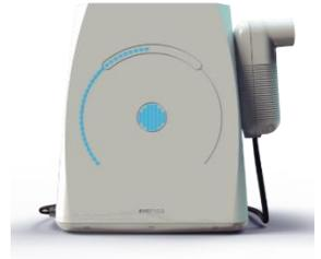
Damit die Entnahme der Luftprobe korrekt ist, muss der Patient den Ausatemfluss regulieren, indem er dem Lichtspiel folgt.
