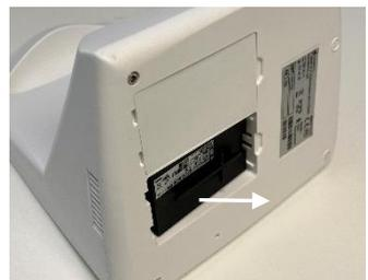
4. Stellen Sie sicher, dass sich keine Gegenstände in der Metallkammer der Kassette befinden. Vergewissern Sie sich, dass die Dichtung (Sensorgummi) nicht in der Kammer verblieben ist. Entfernen Sie in diesem Fall den Gummi in der Kammer.
