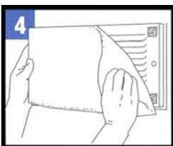
4. Je nach dem Design des Belüftungssystems kann das **Allergy Free** Filtervlies innen oder aussen auf dem Belüftungsgitter befestigt werden.
