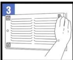
3. Befestigen Sie je einen Streifen des Klettverschlusses in jeder Ecke des Belüftungsgitters.
